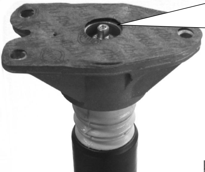
Originale Stützlagereinheit auf den Dämpfer aufsetzen und mit den mitgelieferten Muttern verschrauben. Das Anzugsdrehmoment der Kolbenstangenbefestigung beträgt 20 Nm. Die Montagehinweise zum Einbau des Federbeines in das Fahrzeug, sowie die Anzugsdrehmomente der Federbeinbefestigung, entnehmen Sie bitte den Unterlagen des Fahrzeugherstellers.
