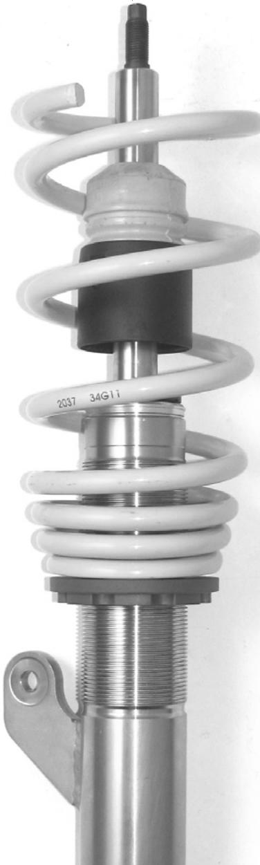
Original Staubschutzrohr an der gestrichelten Linie abtrennen und den oberen Teil auf die Feder aufsetzen. Der untere Teil des Staubschutzes wird nicht mehr benötigt.
