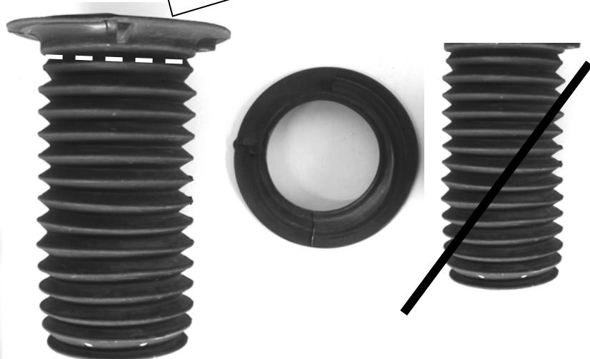
Original Stützlagereinheit mit Gummienteil aufsetzen und mit der mitgelieferten Mutter verschrauben. Das Anzugsdrehmoment der Kolbenstangenbefestigung beträgt 40 Nm. Die Montagehinweise zum Einbau des Federbeines in das Fahrzeug, sowie die Anzugsdrehmomente der Federbeinbefestigung, entnehmen Sie bitte den Unterlagen des Fahrzeugherstellers.
